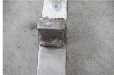
图 4 试验模型疲劳裂纹
