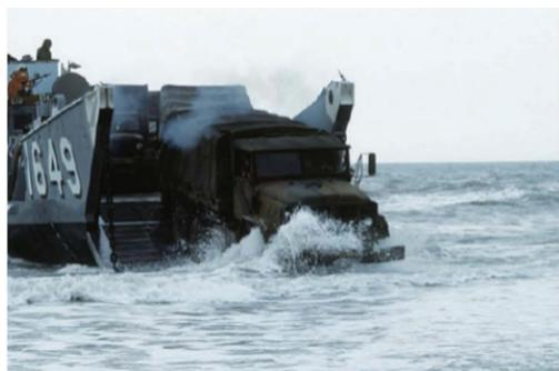
图6 美军 M939 型 5 吨货车泛水卸载
