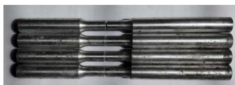
b  $K_t=3$ , 3.5%NaCl 预腐蚀试验件
