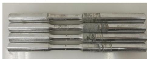
d  $K_t=3$ , 油箱积水预腐蚀试验件
