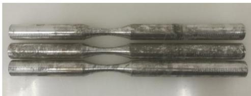
c  $K_t=1$ , 油箱积水预腐蚀试验件
