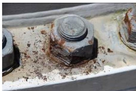
d 螺栓宏观腐蚀形貌 2
