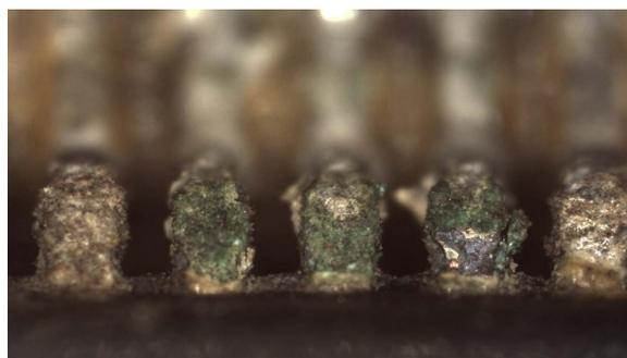
图 12 器件三防缺失和引脚腐蚀
