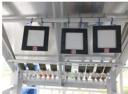
图 3 氯离子沉积速率监测采样
