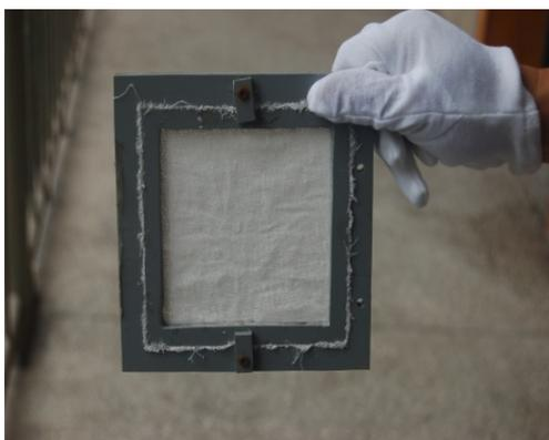
图 1 氯离子沉积速率采样器安装
