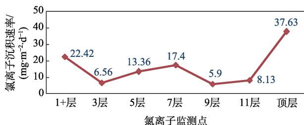
图 4 不同高度层氯离子沉积速率全年分布曲线
