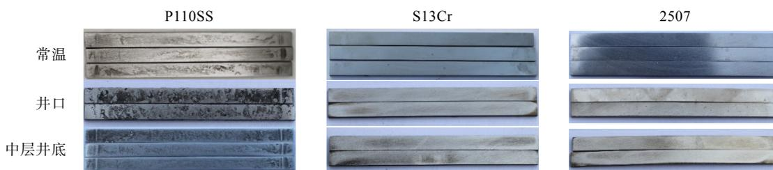
图1 四点弯曲试样去除腐蚀产物后表面宏观形貌
