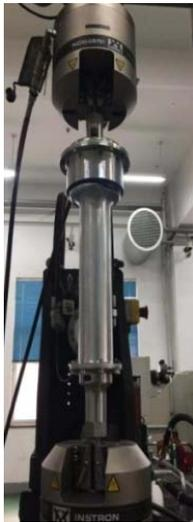
图 3 液-弹隔振器刚度试验
