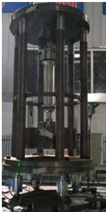
图 9 液-弹隔振器振动特性试验
