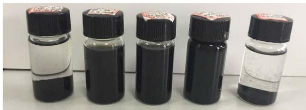
图 7 不同超声时间下氧化石墨烯分散效果图
