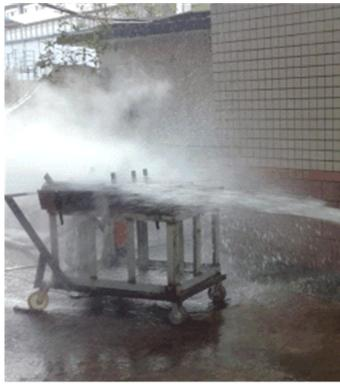
图 3 喷水冷却过程
