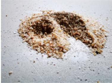
图4 模型试验用标准砂
