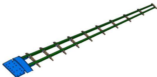
图7 风洞试验模型机翼梁肋分布
