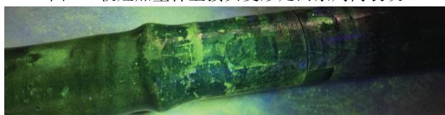
图 7 较短加重杆下接头表面周向裂纹
