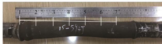
图 4 较短加重杆尺寸测量
