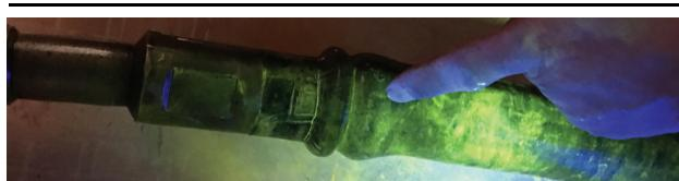
图 6 较短加重杆上接头变形处两条周向裂纹
