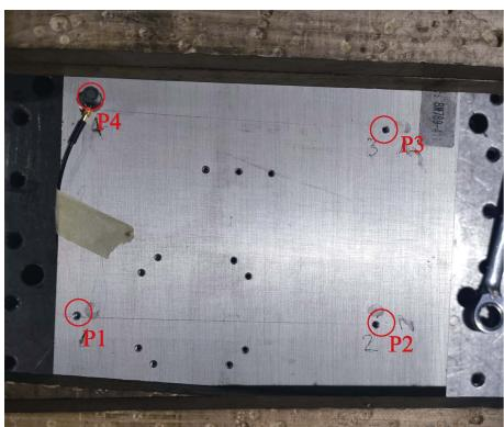
图 7 振动夹具测点位置
