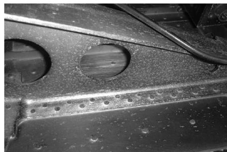
图 4 发动机推力梁腐蚀
