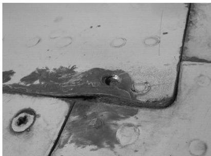
图6 蒙皮缝隙腐蚀
