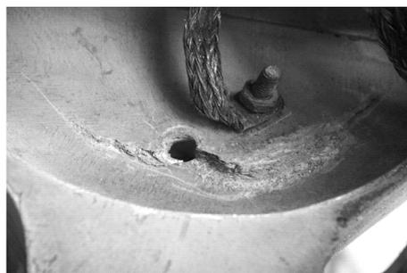
图 2 垂尾下支臂腐蚀
