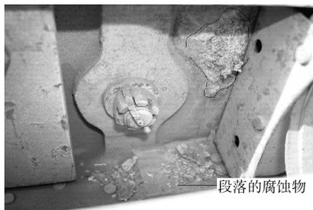
图 3 水平安定面后梁腐蚀
