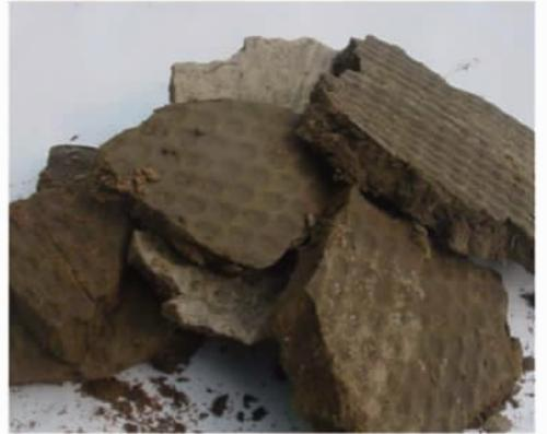
图 5 生物沥浸污泥经厢式压滤机脱水后的污泥饼
