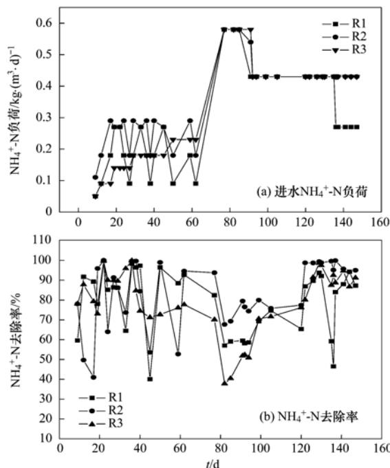
图 8 进水氨氮负荷对氨氮去除率的影响
